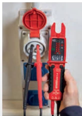
spanningsmeting en draaiveldrichtingstest
