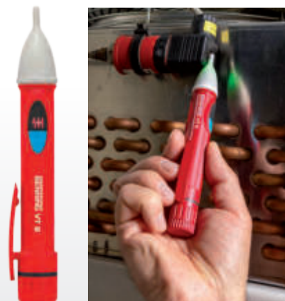
CAT IV 600 V Prüfung eines Magnetventils
