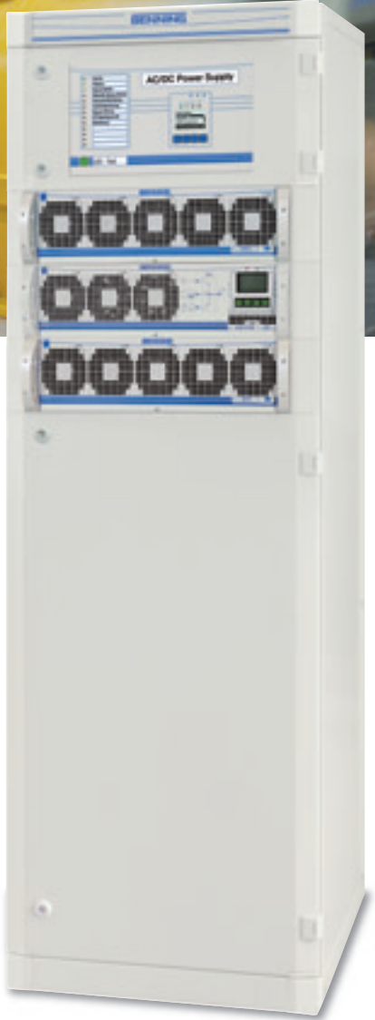
Система Выпрямитель - Инвертер - Преобразователь Выход переменного тока 230В – 4,5 кВА Выход постоянного тока 220В – 50А и 26В – 250А
